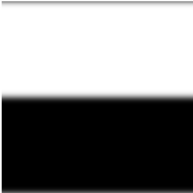
V tomto případě jsme obrázku nepřidali dostatečný zero padding - výsledný obrázek je rozmazaný v horizontálním směru, ale vertikální hrany ne.
